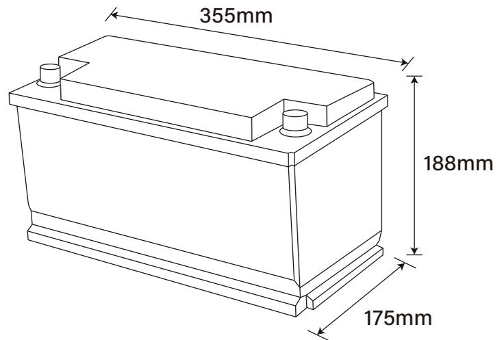
DIN-Standardabmessunge L355 \* W175 \* H188 mm
