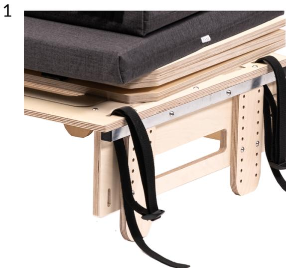
Raxo Monck basiert auf 4 Beinen mit einstellbarer Höhe. Die verstellbaren Beine sind an den Seitenwänden montiert. Jedes Bein wird mit 2 Flügelschrauben montiert. Die Beine haben einen Verstellbereich von 2,5 bis 12,5 cm, und der Abstand zwischen den einzelnen Reihen von Löchern am Bein beträgt 2 cm.
