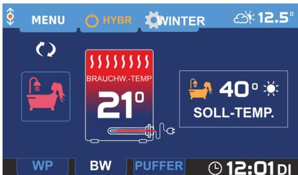
Das Fenster zur Einstellung der Solltemperatur wird durch Drücken des Wortes SOLL-TEMPERATUR auf dem Hauptbildschirm angezeigt. Je nach gewähltem Zirkulationsmodus wird die entsprechende Solltemperatur eingestellt: In der Betriebsart STOPP ist die Möglichkeit, den Temperatursollwert zu ändern, deaktiviert, der Regler zeigt die Solltemperatur von 0°C an.
