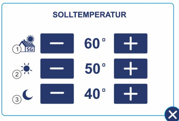
In der Betriebsart Uhrenzone ermöglicht der Regler die Einstellung der Solltemperatur des Brauchwasserkreislaufes für die Zusammenarbeit mit dem SG-Modus (1), den Komfortbereich - ohne Absenkung (2) und für den ECO-Bereich - mit Absenkung (3).
