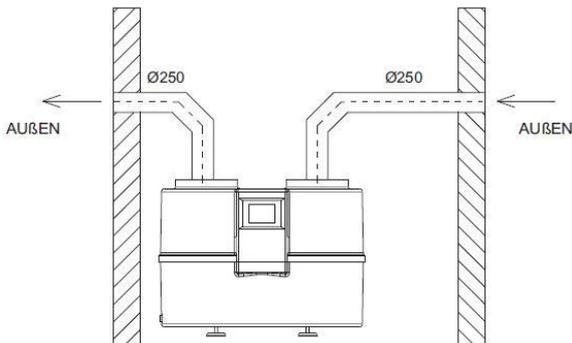
Die durch die Außenwand aufgenommene Luft wird durch die Decke ausgestoßen.
