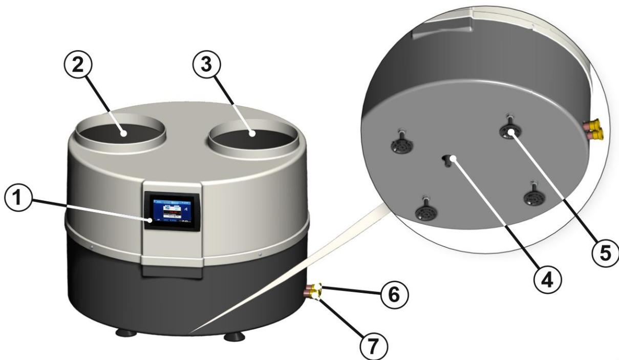
1-Steuerung, 2-Luftaustritt, 3-Lufteintritt, 4-Kondensatablaufanschluss, 5-Wärmepumpenfüße, 6-Warmwasseraustritt, 7-Kaltwassereintritt
