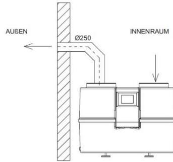
Die durch die Außenwand aufgenommene Luft wird durch die Außenwand ausgestoßen.
