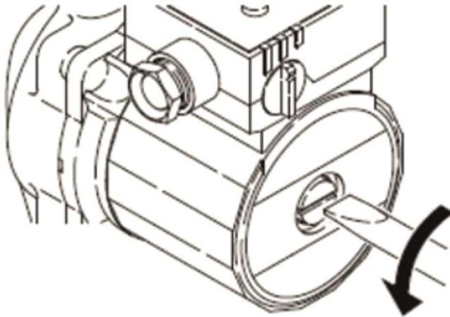
Um die Umwälzpumpe zu entlüften, die Schraube am Pumpengehäuse lösen und warten, bis Wasser unter der Pumpe austritt. Nachdem die Pumpe entlüftet wurde, die Schraube wieder anziehen. Wenn die Umwälzpumpe stagniert, den Strom zur Wärmepumpe abschalten, die Schraube abschrauben und mit einem Schraubendreher das Laufrad bewegen. Nach dem Einschalten der Stromversorgung der Wärmepumpe im manuellen Betrieb die Speicherpumpe starten, um deren ordnungsgemäße Funktion zu überprüfen.
