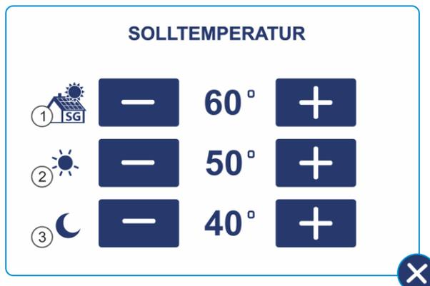
Im Uhrzonenmodus ermöglicht der Regler die Einstellung der Solltemperatur des Pufferkreises für die Zusammenarbeit mit dem SG-Modus (1), den Komfortbereich - ohne Absenkung (2) und für den Öko-Bereich - mit Absenkung (3).
