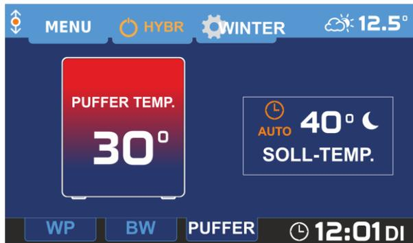
Das Fenster zur Einstellung der Solltemperatur wird durch Drücken des Wortes SOLL-TEMPERATUR auf dem Hauptbildschirm angezeigt. Je nach der gewählten Betriebsart des Kreises wird die entsprechende Solltemperatur eingestellt:
