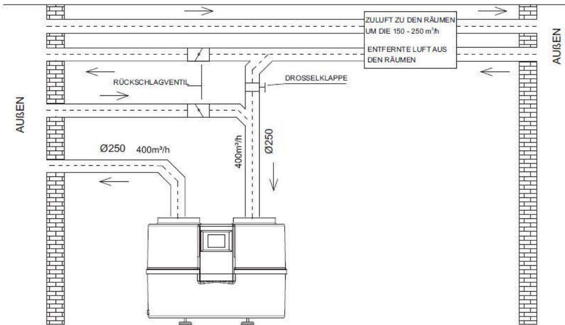
Da die Wärmepumpe und die Rekuperationseinheit unabhängig voneinander arbeiten, sollten auch die Lüftungskanäle getrennt werden. Wenn die Rekuperationseinheit in Betrieb ist und die Wärmepumpe nicht, soll die Luft frei zum Lüftungsauslass und nicht zur Wärmepumpe strömen. Dies würde die Effizienz des Ventilators der Rekuperationseinheit verringern.
