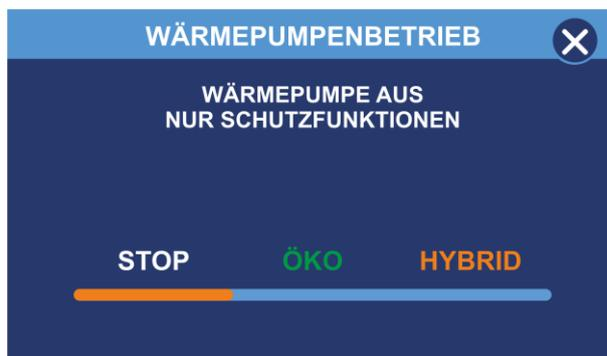
**STOPP- Betrieb** - Wärmepumpe ausgeschaltet.
