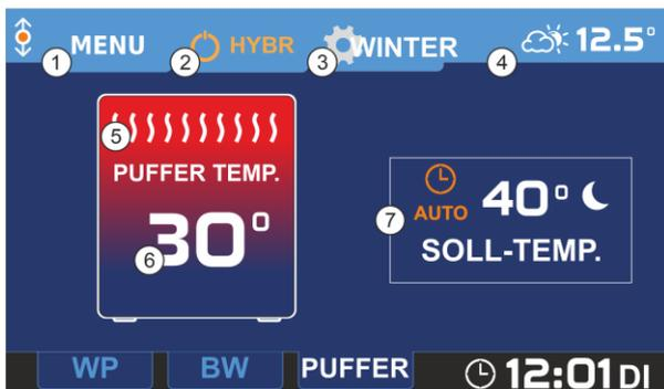
Um in den Bearbeitungsmodus zu gelangen und die Parameter des BUFOR-Kreislaufs einzusehen, die BUFOR-Taste auf dem Hauptbildschirm drücken; auf dem Bildschirm des Steuergeräts wird der BUFOR-Informationsschirm angezeigt.
