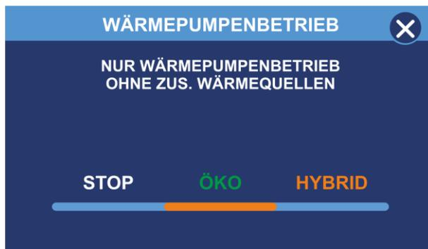
**ÖKO-Betrieb** - Die Warmwasser- und Pufferspeicher-Solltemperaturen können nur bis zur Maximaltemperatur der Wärmepumpe eingestellt werden. Die Elektroheizung wird nur eingeschaltet, wenn die Brauchwasserzusatzladung aktiv ist oder eine Pumpenstörung vorliegt.
