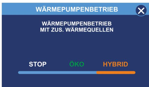
**HYBRID-Betrieb** - Die Warmwasser-Solltemperatur kann über der Maximaltemperatur der Wärmepumpe eingestellt werden. Beim Laden des Speichers arbeitet die Wärmepumpe bis zur maximalen Betriebstemperatur. Oberhalb dieser Temperatur schaltet sich der Heizstab ein.
