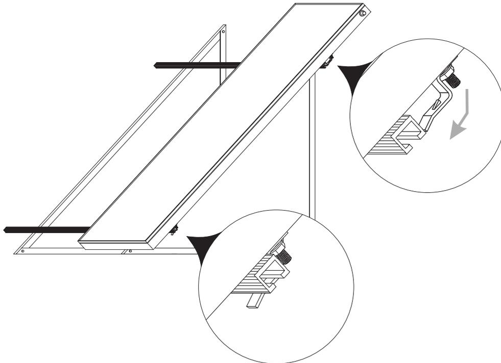
Den Kollektor auf den Balken montieren, dann den Kollektor nach unten schieben und die Schrauben fest anziehen.
