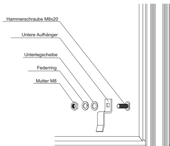
Den unteren Aufhänger anbringen und mit der Hammerschrauben M8x20 fest anziehen
